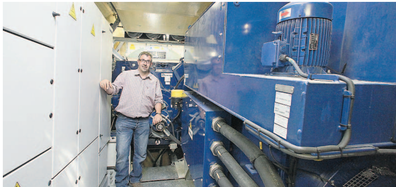
In über 100 Metern Höhe in der Gondel findet sich ein Maschinenraum - dem blauen Generator steht ein Rechenschrank gegenüber (links). Die Dimension der Windkraftanlage mit 125 Meter Narbenhöhe und einem Rotor mit 90 Metern Durchmesser lässt sich am besten mit Abstand erkennen (rechts). Fotos: Distler
